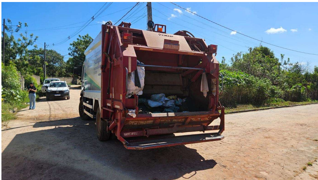
Foto 51 – Parte traseira do caminhão compactador com resíduos acondicionados na boca de carga, demonstrando a etapa de compactação durante a coleta.
