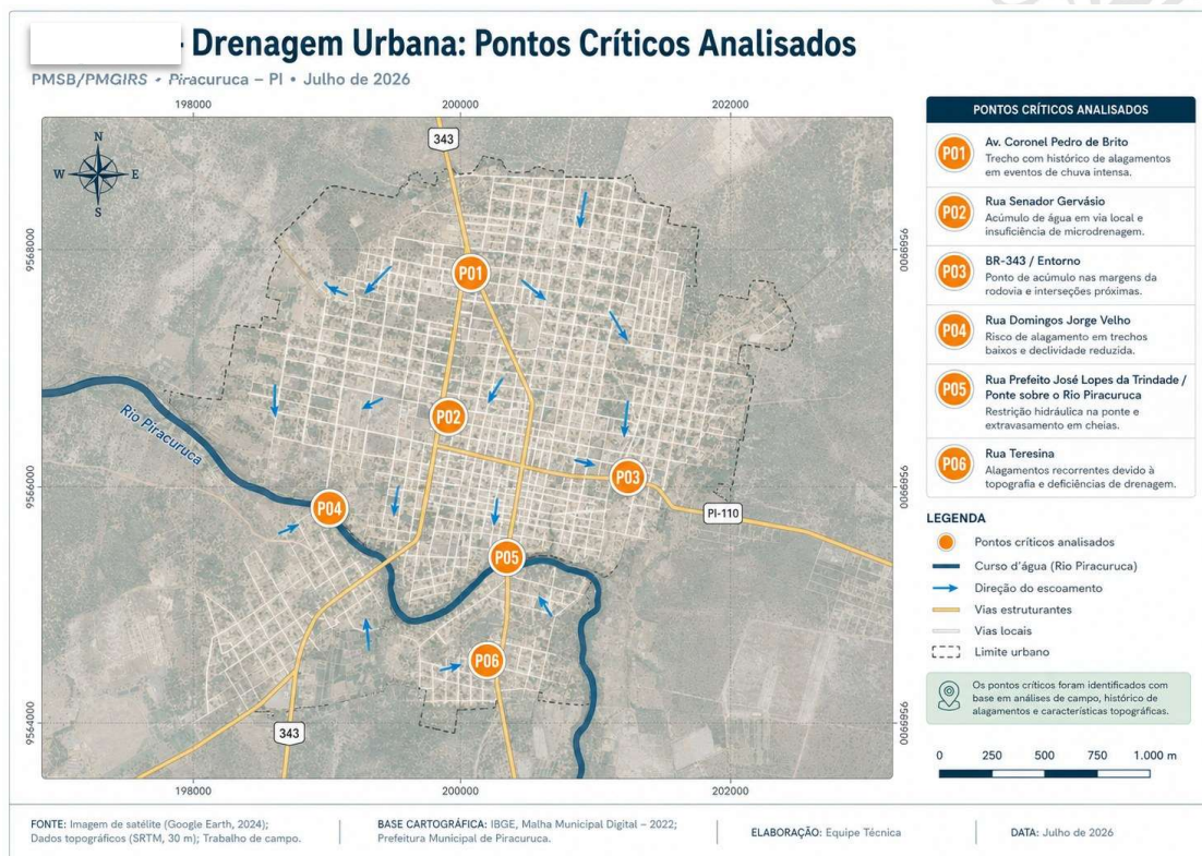
Mapa 18 – Pontos críticos de drenagem e empoçamento.
