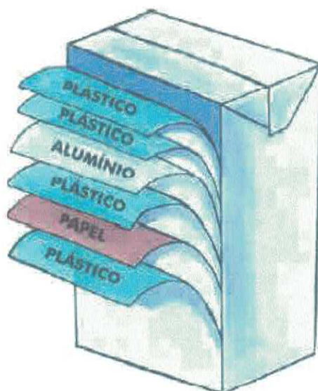
Figura 13 - Constituição de uma embalagem longa-vida
