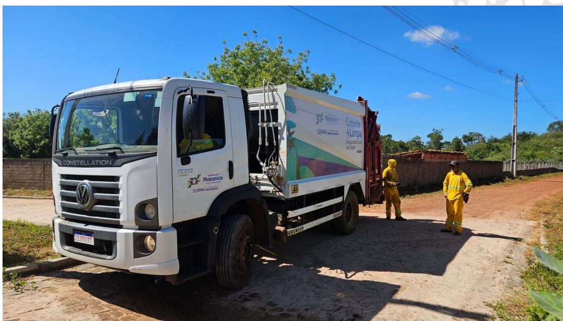
Foto 52 – Vista lateral do caminhão compactador Volkswagen Constellation 17.260 e da equipe uniformizada utilizada no serviço municipal de coleta.
