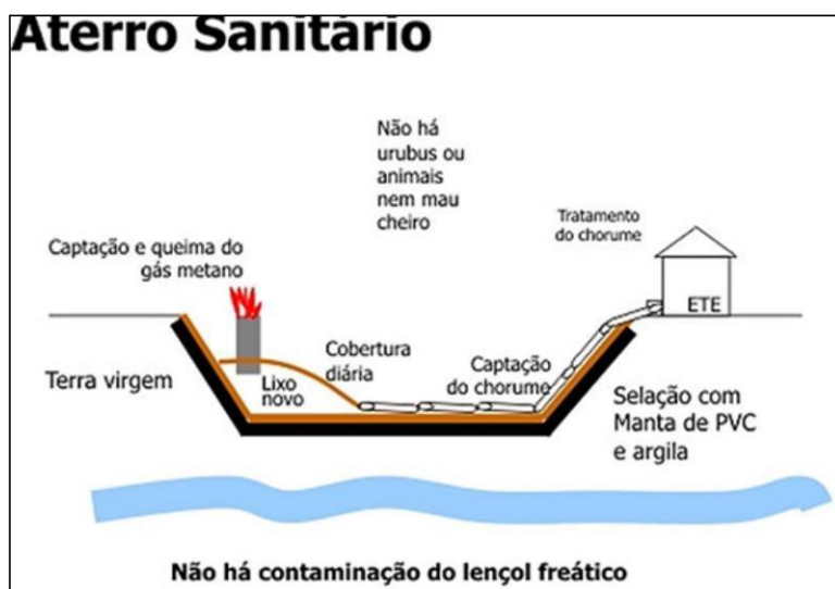
Figura 14 – Exemplo de esquema dos aspectos técnicos de um aterro sanitário
