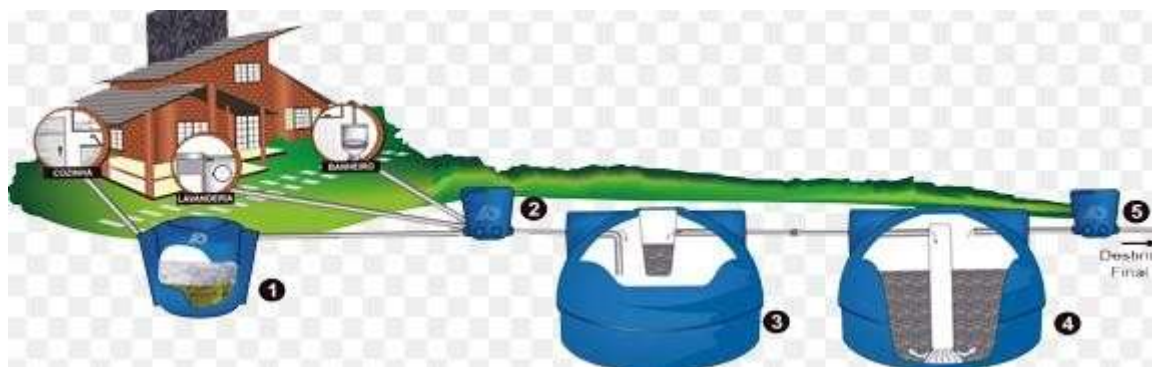
Figura 8: Exemplos de tanques anaeróbios. Fonte: UFOP (2014).
