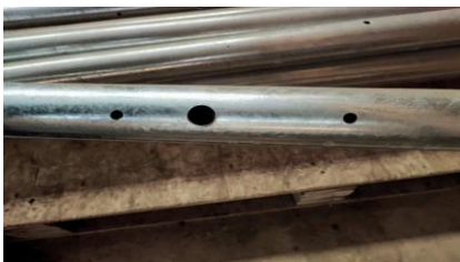
Orifício central para do cabeamento
