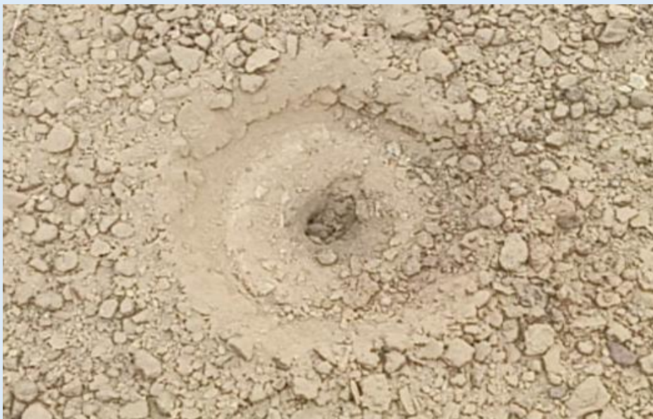
SPT – 02: Areia amarelada com presença de pedregulhos
